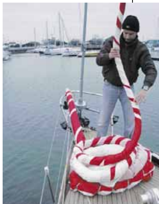
Ecco come si presenta l'asimmetrico avvolto attorno allo strallo gommato del RollGen. Il suo uso richiede un piccolo bompresso.
